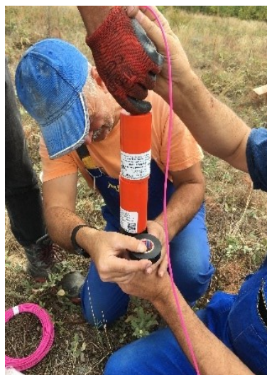
Фигура 4.Изготвяне на междинен заряд от 3 броя бустери тип D5-450
