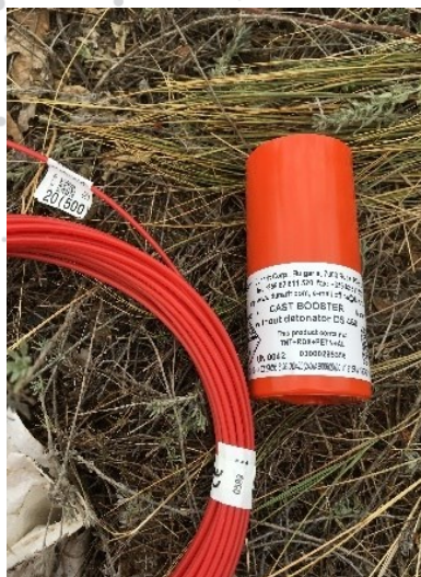
Фигура 4.Изготвяне на междинен заряд от 3 броя бустери тип D5-450
